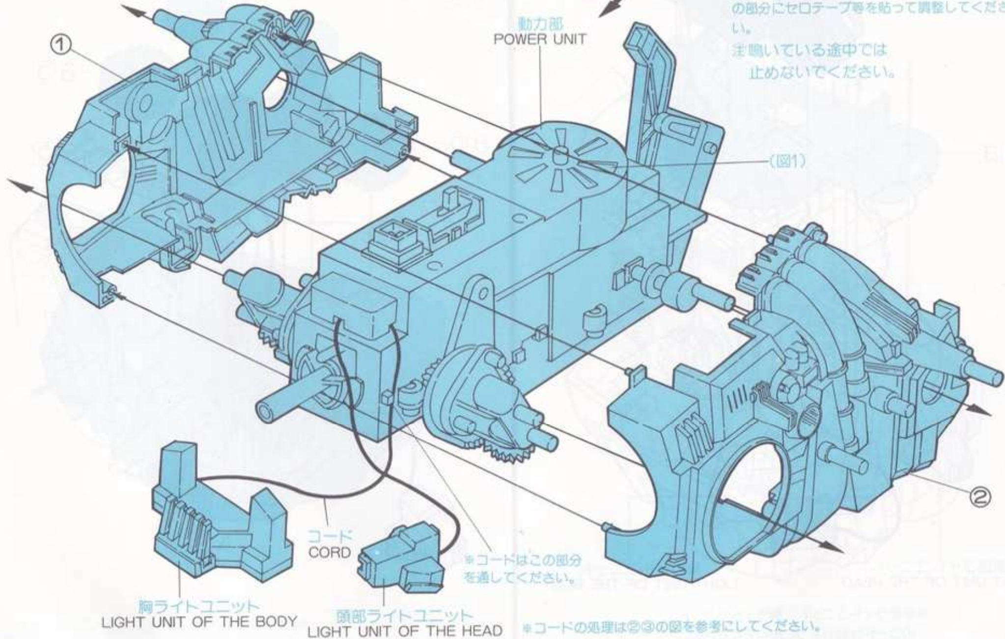
\*本体を組む前に動力部に電池を入れ、動かしてください。音が大きいようでしたら、(図1)の穴部分にセロテープ等を貼って調整してください。
