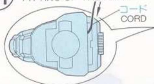
\*頭部を取り付ける時は、頭部下側のすきま部分にコードを押し込みながらセットしてください。本体と頭部の間にコードを、はさまないようにしてください。
