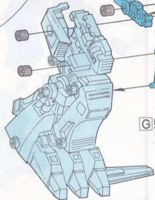
\*G49を組む場合は、G39をはさみ込むようにして組み、さらに矢印の方へ回しながら左図の位置でセットしてください。
